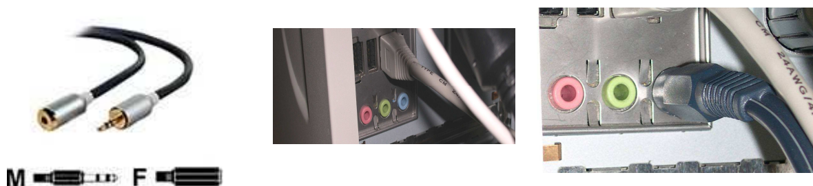
Figure 2 – Câble mini-jack mâle et branchement au pc
